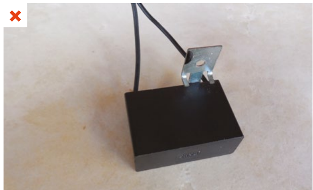
Condensateur défaillant, à l'origine de la panne d'un brasseur d'air. ©AQC
