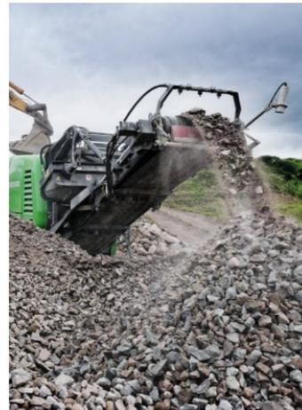
Recyclage des déchets inertes de chantier ci-dessus, Intégration du verre concassé ci-dessous (Photos : Eiffage TP)
