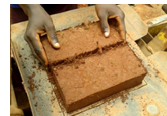
Brique stabilisée avec des fibres naturelles - source : makery.info
