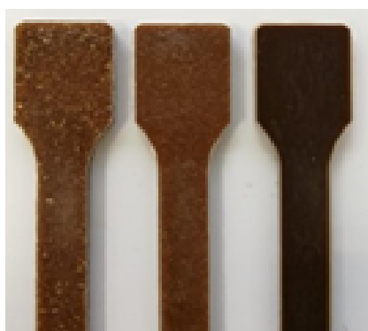
Eprouvettes biocomposites intégrant des fibres d'ananas et de bananier, Projet GUYAVALOFIBRES, 2018-2019
