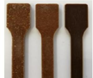
Eprouvettes biocomposites intégrant des fibres d'ananas et de bananier.
